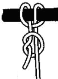
Рис. 24. Использование узла «Стремя» для крепления веревки к опоре
