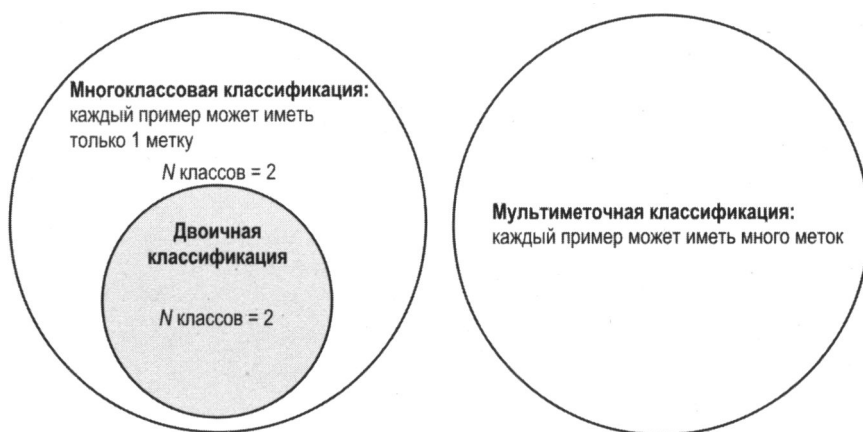
Рис. 3.8. Понимание отличия между многоклассовой, мультиметочной и двоичной классификационными задачами
