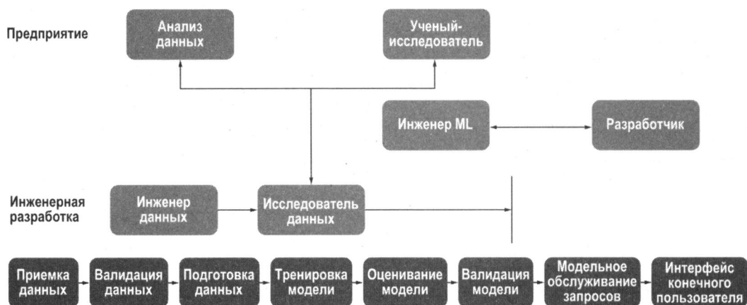
Рис. 1.2. С данными и машинным обучением связано много разных должностных ролей, и эти роли сотрудничают в рабочем потоке процессов ML — от приемки данных до разработки API и интерфейса конечного пользователя. Например, инженер данных работает с приемкой и валидацией данных и тесно сотрудничает с исследователями данных
