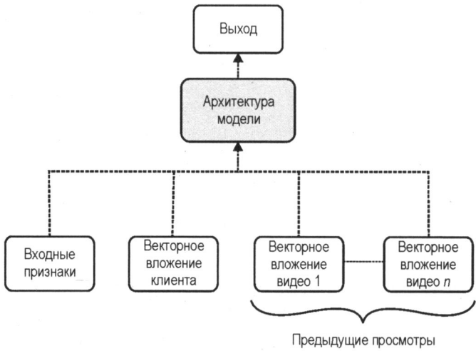
Рис. 2.10. Усваивая низкоразмерный, плотный вектор вложения для каждого клиента и видео, модель, основанная на векторных вложениях, способна неплохо обобщать с меньшей косвенной нагрузкой, связанной с ручной инженерией признаков
