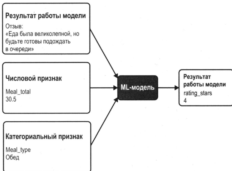
Рис. 2.20. Модель, сочетающая входной текст произвольной формы с табличными данными для предсказания оценки ресторана посетителем
