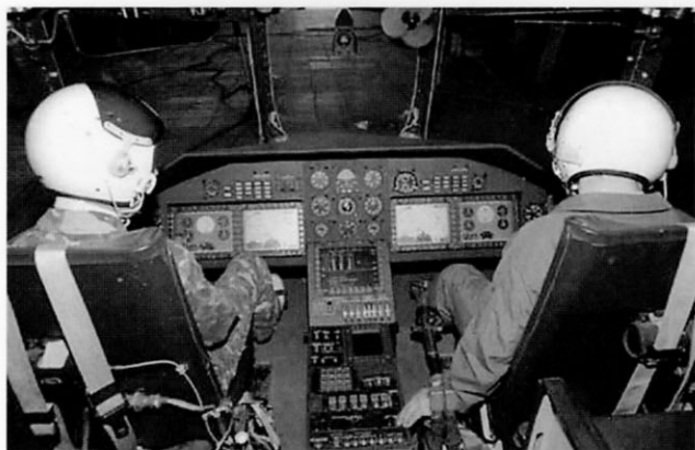
Кабина Ми-17МТВ-5. Большинство прежних стрелочных электро-механических приборов заменены современными дисплеями
