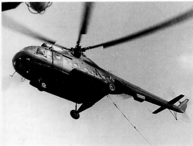
Буксировщик трала Ми-8БТ во время испытаний на Черном море
