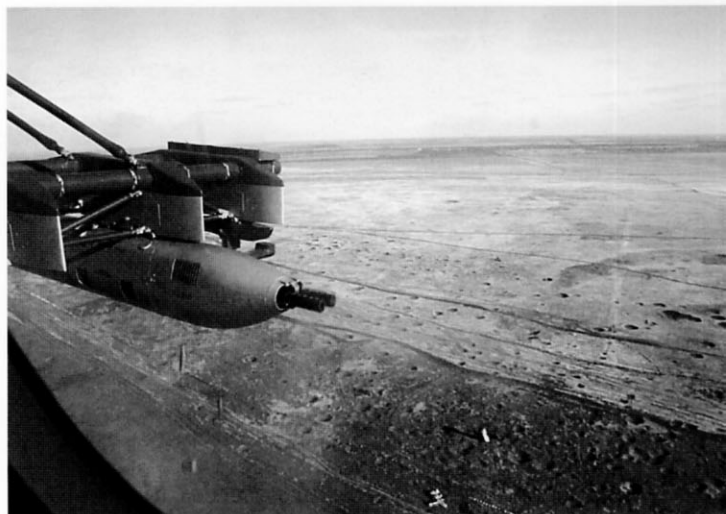
Ми-8МТ с подвеской пушечного контейнера УПК-23-250 над полигоном. Внизу на изрытой воронками земле разбросаны обломки мишеней
