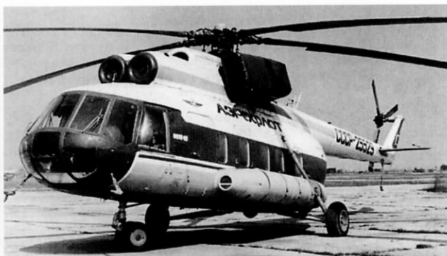
Ми-8МТ гражданского исполнения с эжекторно-выхлопными устройствами на соплах двигателей
