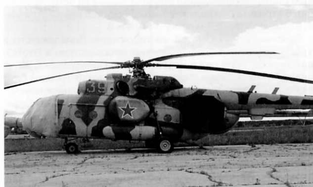
Постановщик помех Ми-8МТШЗ со станцией РЭБ «Шакта» и другим помеховым оборудованием
