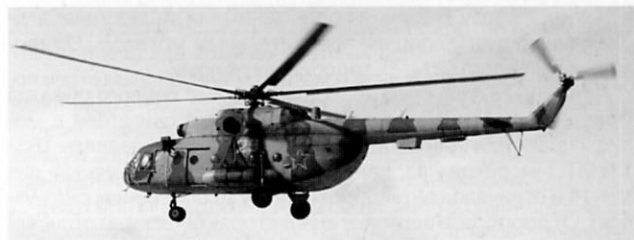
Благодаря хорошей энерговооруженности Ми-8МТ обладал высокой скороподъемностью и лучшей управляемостью, будучи наиболее любимой летчиками модификацией вертолета
