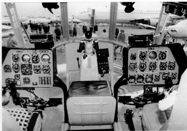
Кабина Ми-8МТКО. По центру – рабочее место оператора наведения ПТУР
