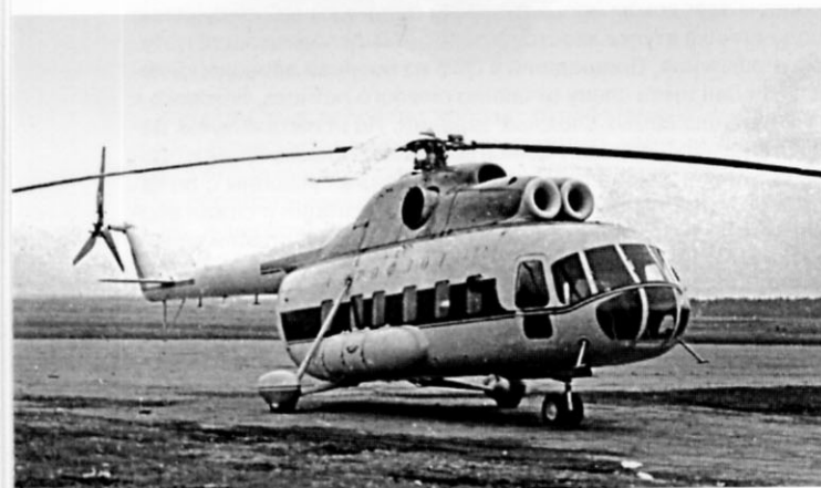
В-8А в ходе испытаний получил «дизайнерские» обтекатели основных колес и стоек шасси. В гондole справа по борту размещался обогреватель кабин КО-50
