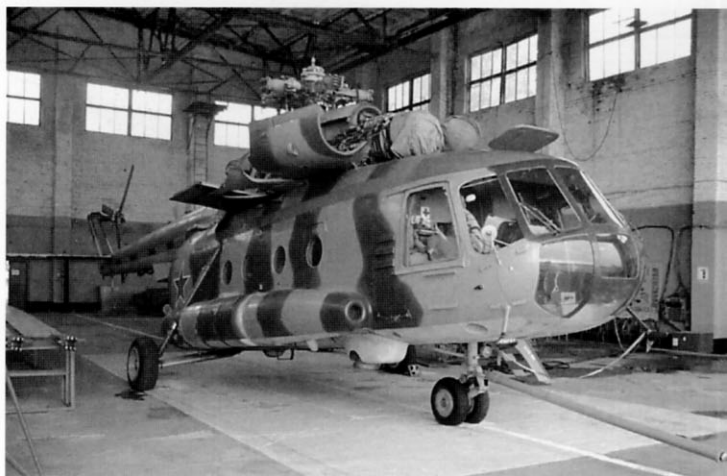
«Восьмерка» поисково-спасательной службы несет громкоговорящее устройство под фюзеляжем
