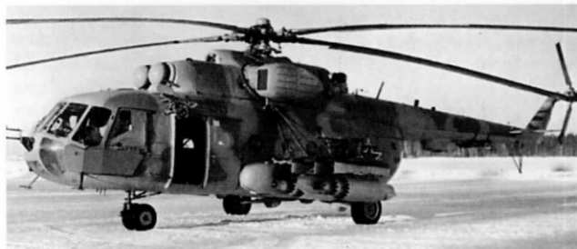
Ряд доработок Ми-8МТ был выполнен по требованиям афганской кампании. Запечатленный на заводском аэродроме вертолет оснащен пылезащитными устройствами двигателей, дополнительным бронированием кабины, усиленным вооружением с носовым и ферменными пулеметами ПКТ, а также кассетами тепловых ловушек и станцией инфракрасных помех зенитным ракетам
