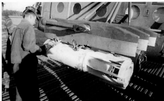
Подвеска осколочно-фугасной бомбы ОФАБ-250-270 на вертолет
