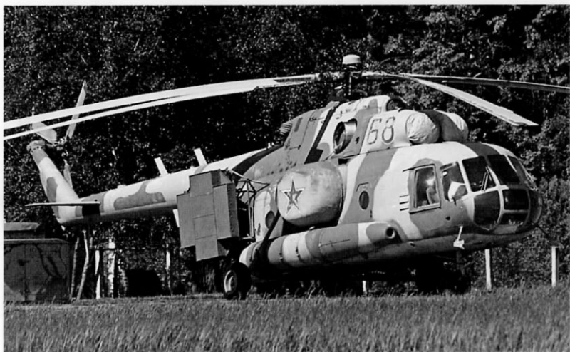
Вертолет Ми-8МТШ с помеховой станцией «Шахта»
