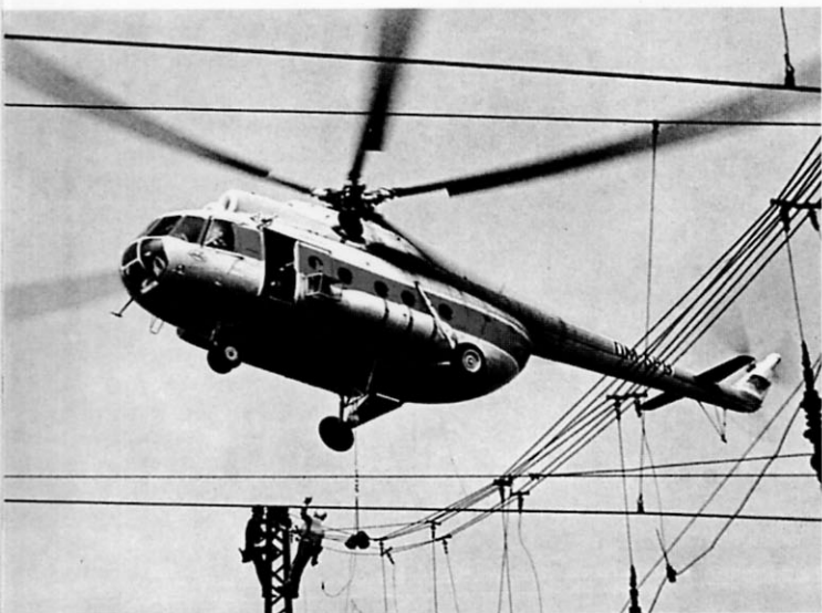
Этот Ми-8Т использовался в ГДР для монтажных работ, где местные специалисты своими силами оснастили его остекленной кабинкой для возможности наблюдения за местом выполнения работ без открытия двери
