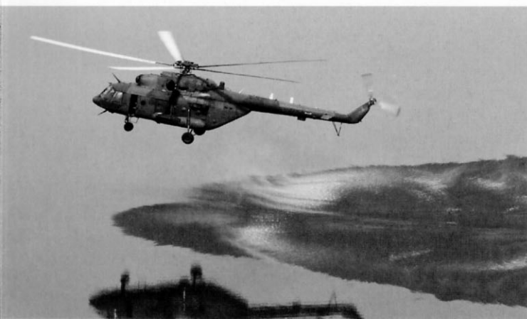
Эффектный проход венесуэльского Ми-17-1В над морской гладью. Вертолет оснащен резаками американского образца в носовой части на случай столкновения с проводами при полетах на малых высотах
