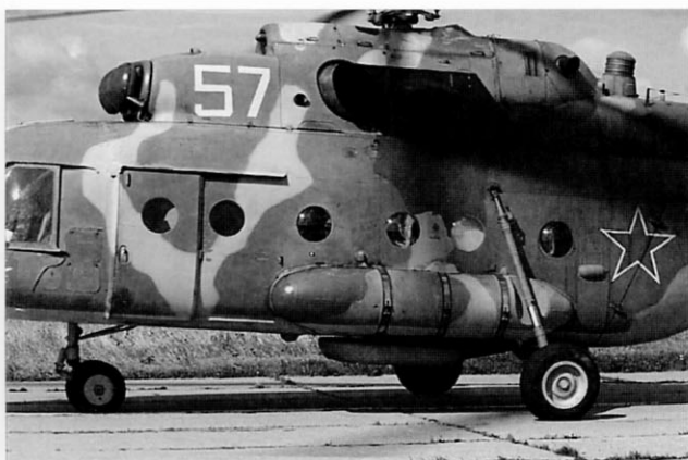
Вертолет Ми-8МТЛ. Под фюзеляжем виден обтекатель антенны ретранслятора
