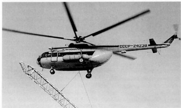
Вверху: в «Аэрофлоте» вертолет нашел самое широкое применение: от грузовых и пассажирских перевозок и до монтажных операций в роли летающего крана
