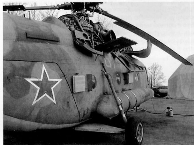
«Раскапаченный» Ми-8СМВ демонстрирует хорошие возможности по обслуживанию «восьмерки», открытые капоты которой служили рабочими трапами, с помощью чего практически ко всем узлам силовой установки и несущей системы можно было добраться безо всяких стремянок и прочих громоздких наземных средств
