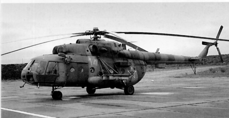
Ми-8МТ визуально отличался от предшественника укороченными гондолами силовой установки и измененным расположением хвостового винта
