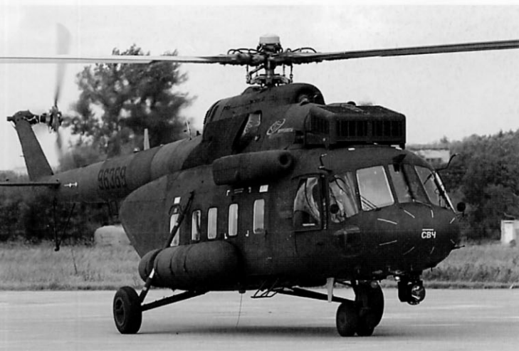
Экспортный Ми-17-1В салонного исполнения производства Казанского вертолетного завода. Вертолет оснащен ПЗУ корбчатого типа и поисковым прожектором
