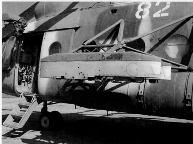
На балочных держателях могли подвешиваться бомбы калибра до 500 кг и блоки реактивных снарядов
