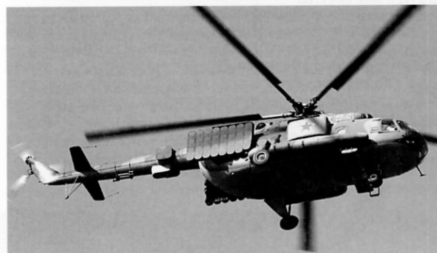
Наименование вертолетов-постановщиков помех напрямую восходило к установленному на них оборудованию: Ми-8МТПБ являлся носителем станции «Бизон»
