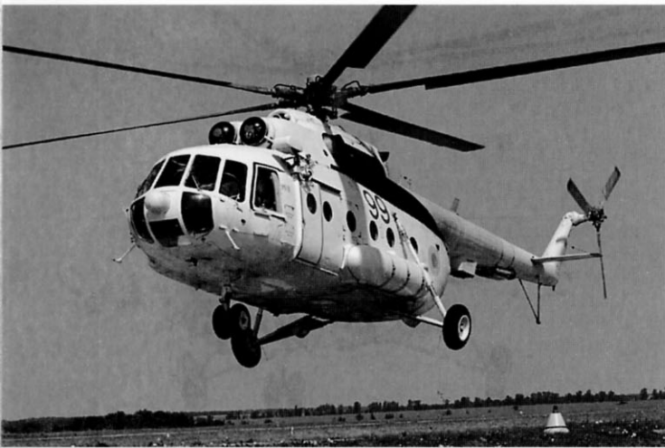
Ми-8МТ с доработкой – установкой малогабаритной РЛС вместо центральной панели остекления кабины. Для работы по контракту с гуманитарной миссией ООН вертолет перекрашен полностью в заметный белый цвет, подчеркивающий нейтральность машины в местном конфликте
