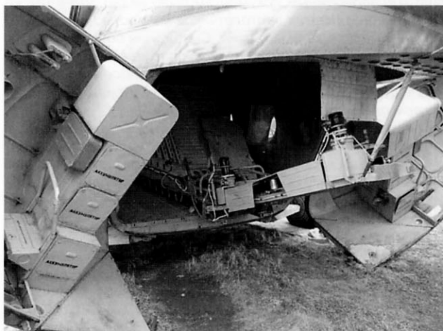
Установка минного раскладчика ВМР-2 в грузовой кабине Ми-8
