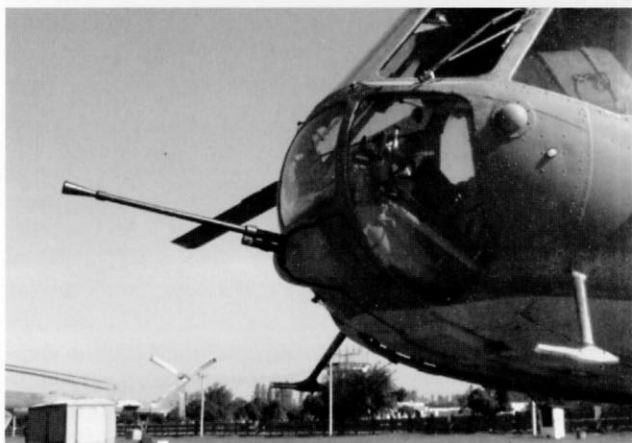
Установка крупнокалиберного пулемета А-12,7 на вертолете Ми-8ТВ. При стрельбе створки установки открывались, освобождая пулемет во всем секторе обстрела
