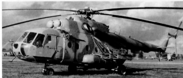
Ми-8МТ с «афганскими» доработками на заводском аэродроме в Люберцах. Вертолет не имеет ПЗУ и станции «Липа». Ферменные пулеметы не установлены, но рамы для них присутствуют
