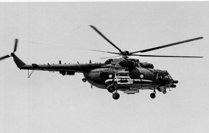
Ми-8МТКО с двумя «шариками» гиросtabilизированной обзорно-прицельной системы и аппаратурой наведения ПТУР
