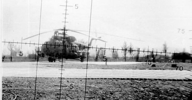
Вид через визир бомбардировочного прицела ОПБ-1Р. По диаметру сетки нанесена вертикальная курсовая черта с параллельными чертами определения угла сноса. Поперечная черта служит для оценки боковых отклонений и учета угла смещения, по окружности – круговая шкала, оцифрованная делениями по 5°
