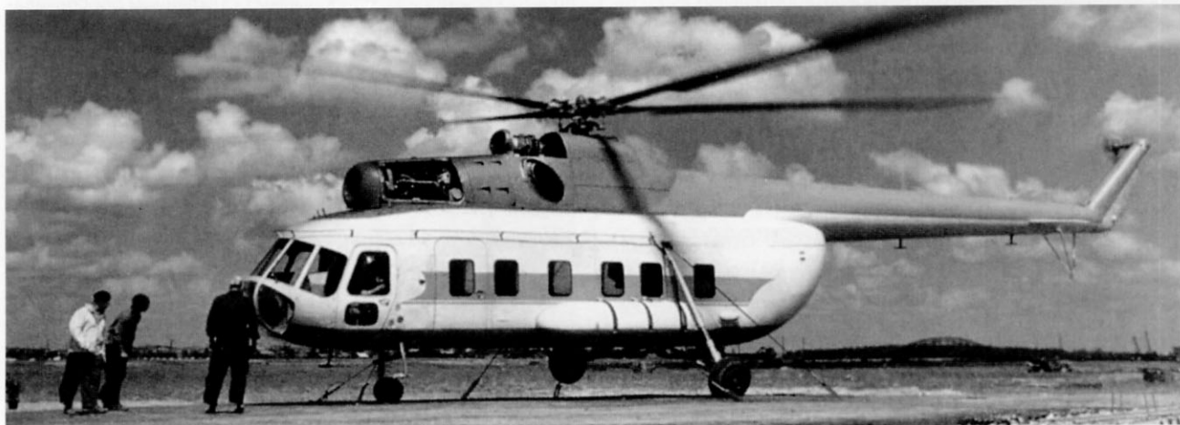
Первый полет прототипа В-8 на привязи. Для лучшего охлаждения двигателей и вентилятора капоты сняты. Возле машины крайним слева стоит М.Л. Миль
