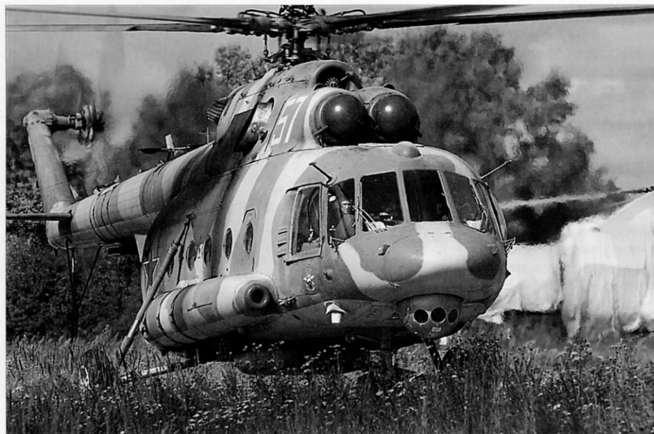
Вертолет Ми-8МТЛ с трехканальной гиросtabilизированной турелью под носовой частью
