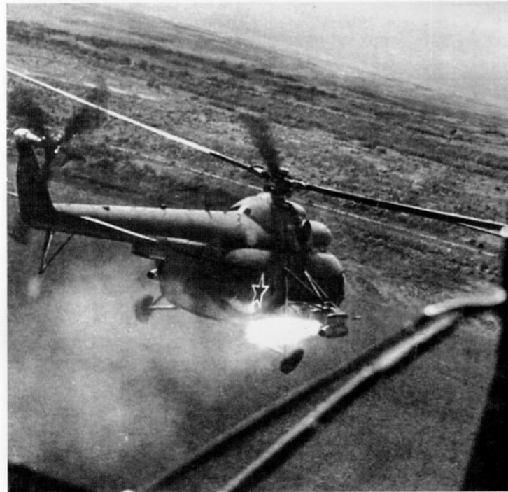
Стрельба реактивными снарядами типа С-5 с вертолета Ми-8Т
