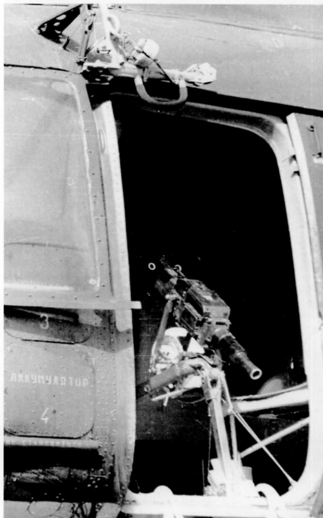
Автоматический гранатомет АГС-17 «Пламя» в двери Ми-8Т. Хорошо видны растяжки крепления установки к швартовочным узлам грузовой кабины
