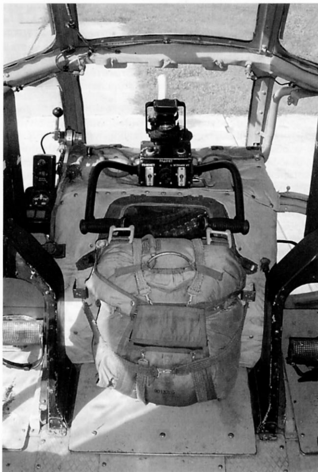
С л е в а : рукоятки управления и прицел К-10Т пулеметной установки. Тут же приторочен парашют стрелка-борттехника
