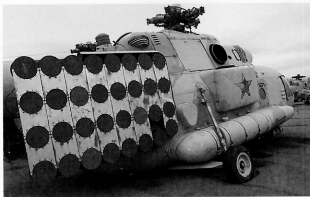
Панели с антеннами станции «Бизон» вертолета Ми-8МТПБ
