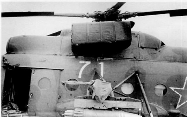
Эжекторно-выхлопные устройства раннего образца на патрубках двигателей Ми-8Т. 280-й овп, Кандагар, март 1981 г.
