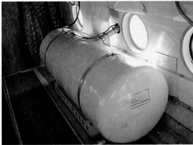
Для увеличения дальности полета вертолет оборудовали дополнительными баками в кабине емкостью 915 л
