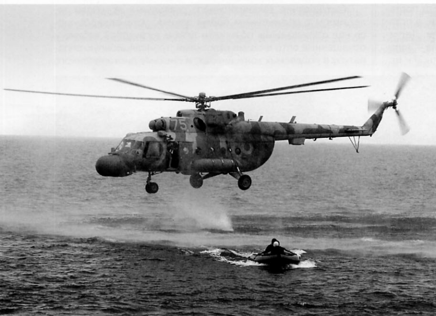
Ми-8МТЮ с установкой мощной поисковой РЛС имел наиболее экзотический вид во всем обширном семействе
