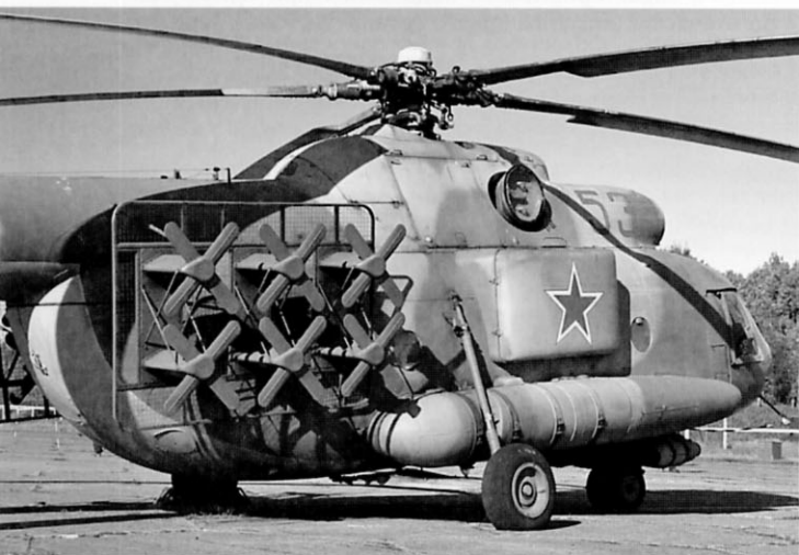
Характерные антенны станций «Фасоль» закрепили за вертолетом Ми-8ППА прозвище «мельница»
