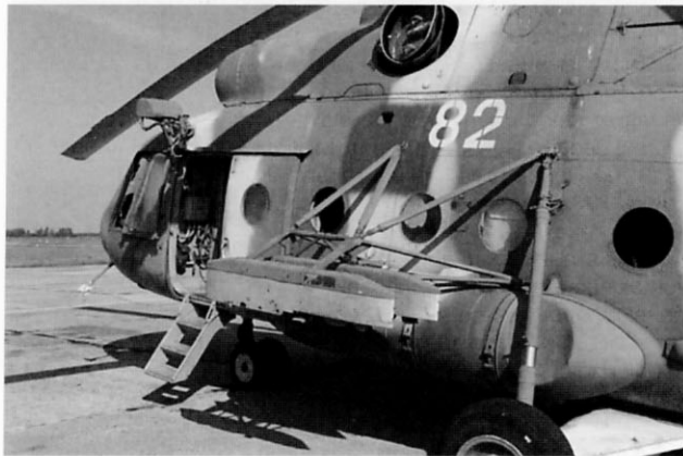
В армейском исполнении Ми-8Т комплектовался фермами подвески вооружения, а также смонтированной у двери лебедкой для подъема грузов и людей с земли на висении
