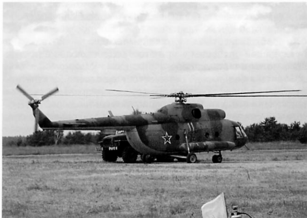
Запуск двигателей Ми-8Т. Запуск можно было производить и от бортовых аккумуляторов, но для экономии зарядки источником питания служит машина аэродромного пускового агрегата
