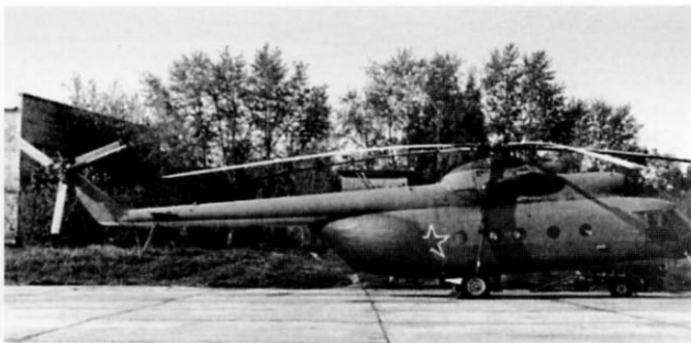
Ми-8 с аэродинамическими улучшениями – удлиненными створками грузолюка, обтекателями выхлопных сопел двигателей и втулки несущего винта
