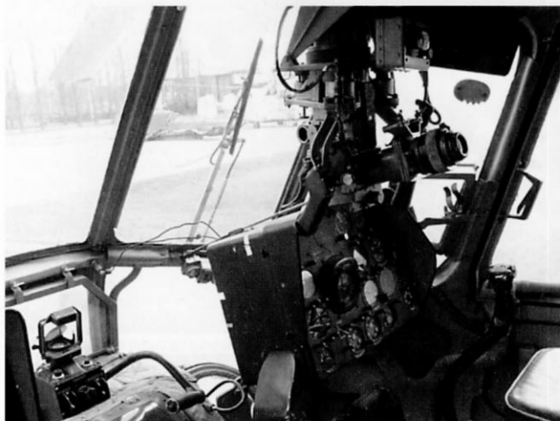
Прибор наведения ПТУР над рабочим местом штурмана-оператора вертолета Ми-8ТВ
