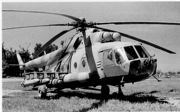
Ми-8МТ с набором бомбового и реактивного вооружения, дополнительным бронированием кабины и пулеметом ПКТ в носовой установке
