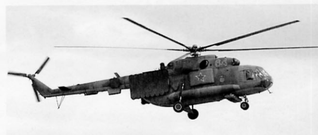
Под фюзеляжем Ми-8МТПБ размещались радиаторы жидкостного охлаждения аппаратуры
