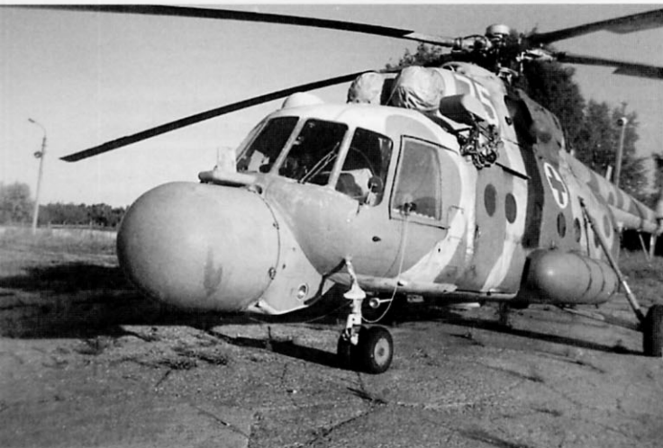
Ми-8МТЮ с установкой мощной поисковой РЛС имел наиболее экзотический вид во всем обширном семействе
