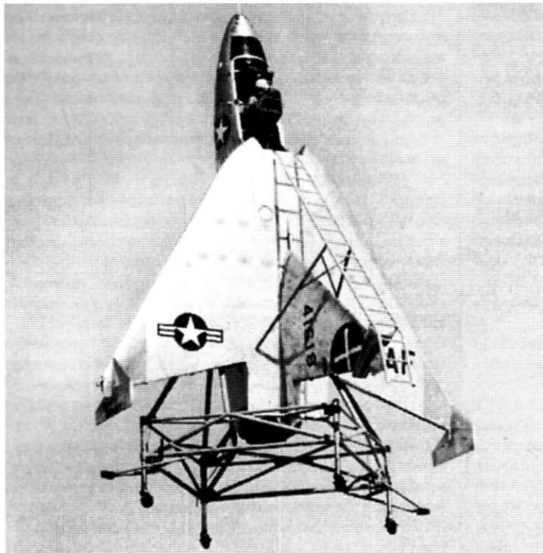
Американский экспериментальный СВВП «Райан» X-13
