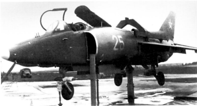
Опытный экземпляр Як-36М на стенде для исследования действующих на него сил во время взлета
