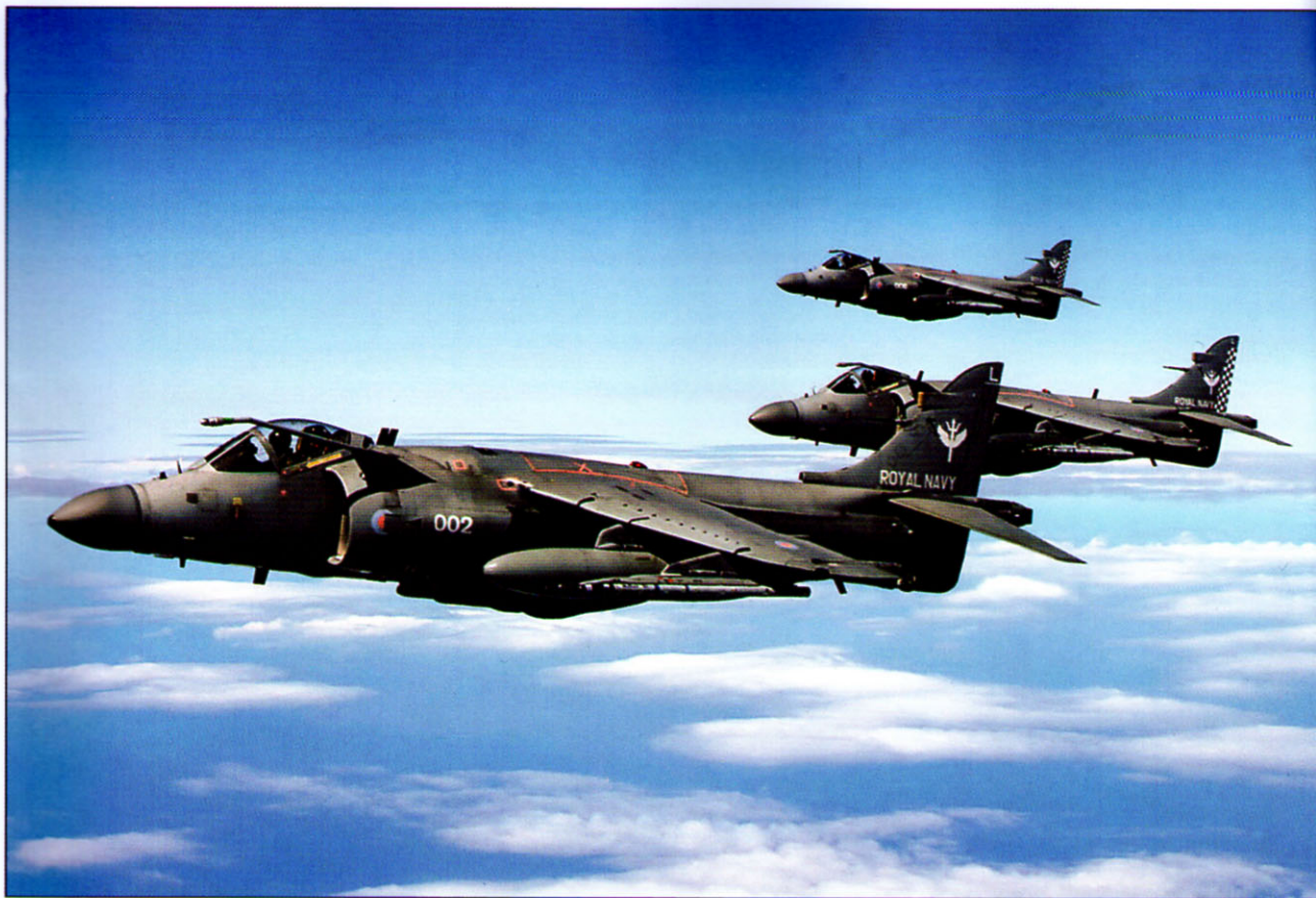
«Си Харриеры» FRS.2 в новом сером камуфляже. На самолетах смонтированы съемные штанги для дозаправки в воздухе
