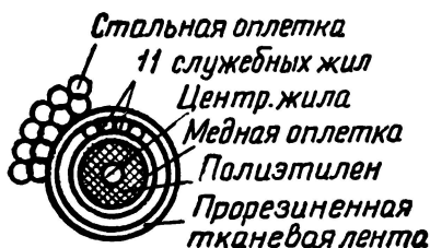
Рис. 1. Сечение кабеля-троса
